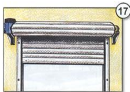
βήμα 17 : τύλιγμα του ρολού στον άξονα με κίνηση από το μοτέρ. Μόλις τυλιχθεί ολόκληρο το ρολό αρχίζουμε να το ξετυλίγουμε μέσα στους οδηγούς
